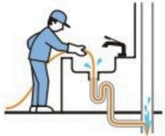
水を高圧で噴射して排水管内部の汚れをすっきりと落とします。すべての排水管内部を専用の技術で洗浄します。
